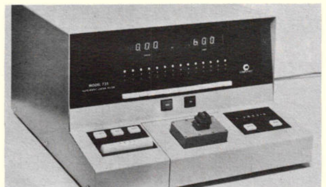
Afb. 5. Automatische tester voor analoge IC's, model 725.
