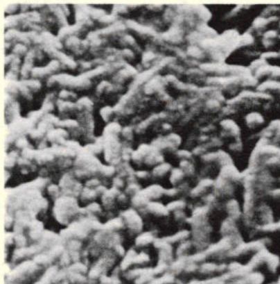
Opname van magneetband, dat ca. 40 000 maal is vergroot.
